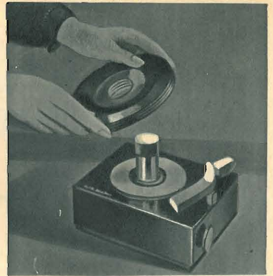
● L'originalità di questo giradischi a microsolfi a 45 giri sta nel cambiadischi automatico posto in centro e privo di braccio. Esso richiede però dischi con centro più spesso per evitare danni ai solchi.
